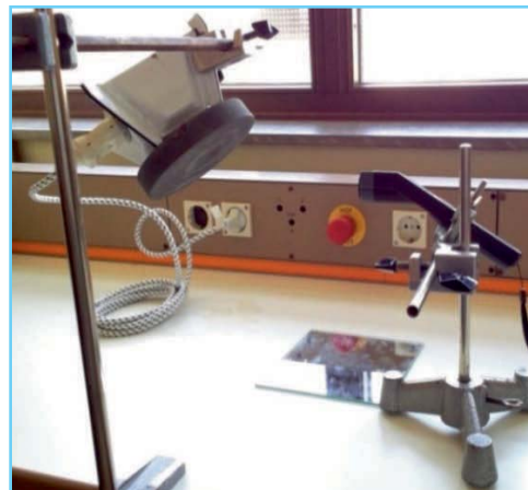
Abb. 7. Direktes Anvisieren der erwärmten Heizplatte zur Feststellung der Anfangstemperatur (Anzeige 113^{\circ}\text{C} )
