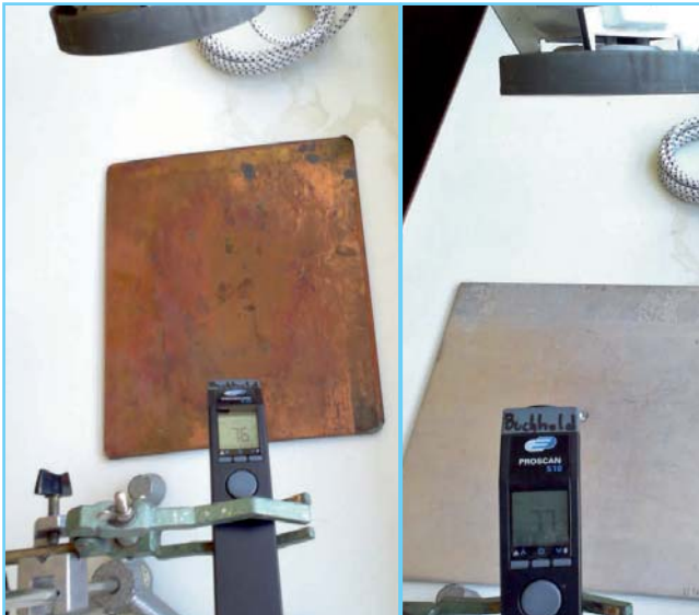
Abb. 9. Erhöhte Reflexion durch die Kupfer- und Aluminiumplatte (Anzeige 76 °C bzw. 77 °C)
